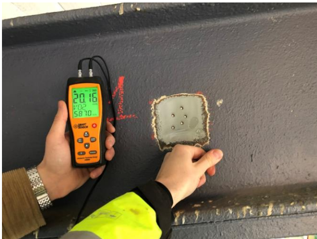
Foto Nr. 36 Dubult T40 sienīņas biežuma uzmērījums – 20mm.
