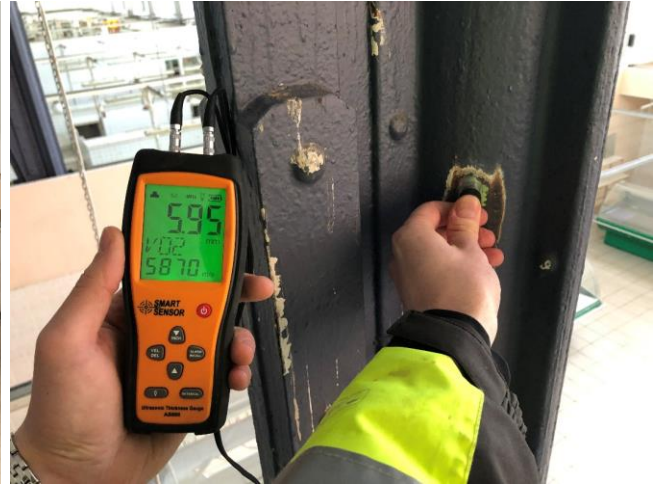
Foto Nr. 35 Kolonnas sienīņas biežuma uzmērījums – 6mm.
